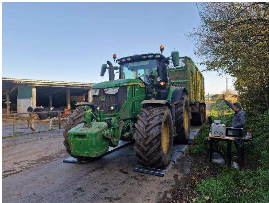
Figura 4. Equipo de calibrado de medida de producción y materia seca en cosechadoras de forraje
