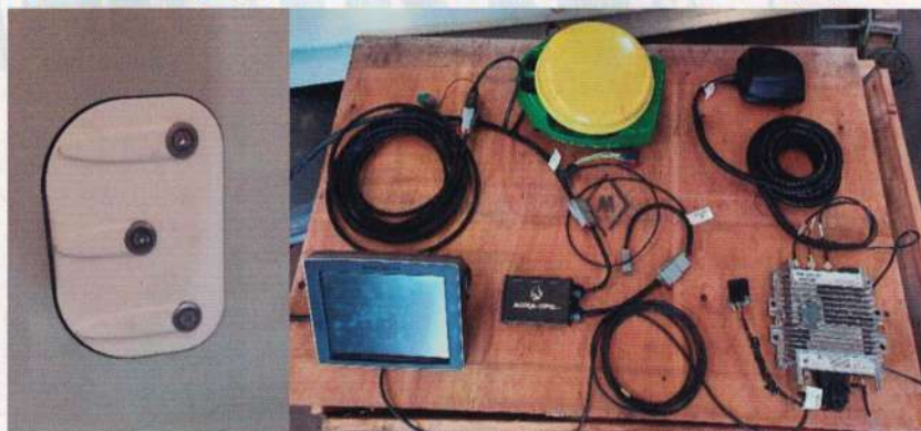
Figura 5. Sensores y equipos adicionales instalados en las cosechadoras autopropulsadas
