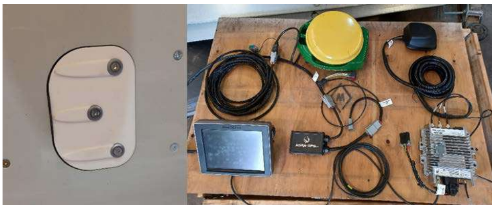
Figura 5. Sensores y equipos adicionales instalados en las cosechadoras autopropulsadas. Izquierda: sensor de humedad del forraje en el tubo de descarga. Derecha: equipos instalados en cabina para la adquisición, georreferenciación y transmisión de los datos.
