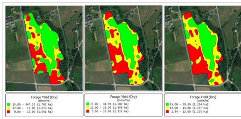
Figura 6. Mapas de rendimiento con tres zonas de manejo elaborados con un archivo sin limpiar (izquierda), con limpieza manual (centro) y con limpieza automática (derecha).
