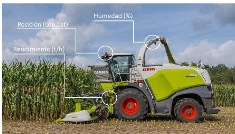
Figura 1. Sensores necesarios para obtener mapas de rendimiento en cosechadoras autopropulsadas de forraje
