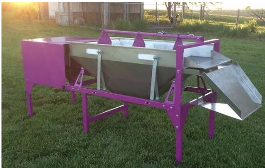
Ilustración 53 Máquina de despalillar infrutescencias de saúco. Modelo T.E.D. Fuente: [https://www.riverhillsharvest.com/ted]
