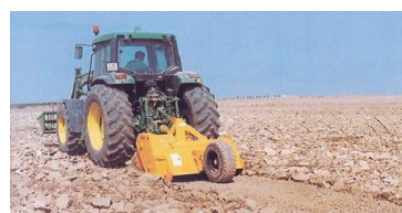
Ilustración 17 Labor de despedregado. Recogida y carga o machaqueo.
