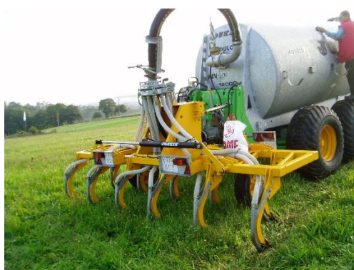
Ilustración 20 Abonado orgánico con purín aplicado con cisterna con inyectoras
