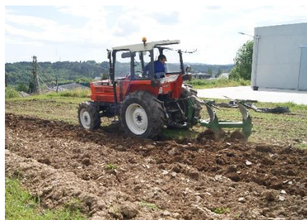
Ilustración 16 Arado de vertedera cuatrisurco y labor de vertedera con bisurco
