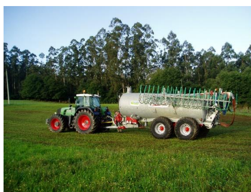
Ilustración 20 Abonado orgánico con purín aplicado con cisterna con inyectoras
