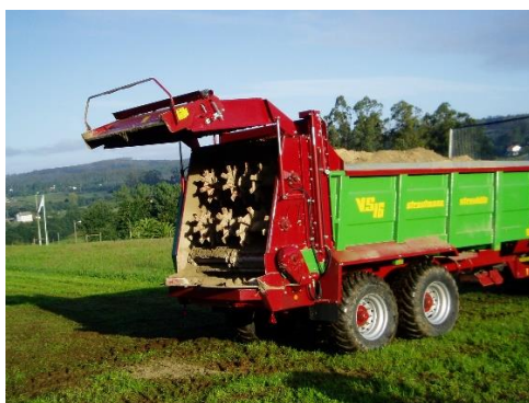
Ilustración 19 Abonado orgánico con remolque esparcidor de estiércol
