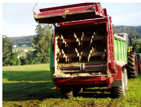
Ilustración 19 Abonado orgánico con remolque esparcidor de estiércol
