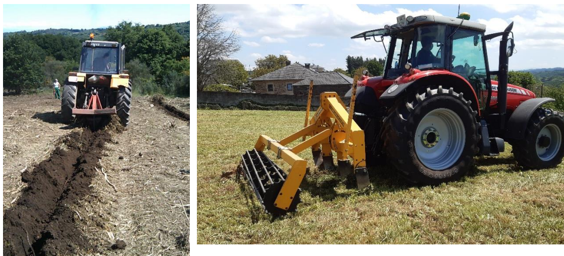
Ilustración 15 Labor de subsolado, con una o cuatro rejas
