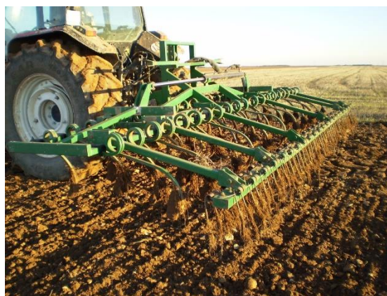
Ilustración 24 Pase de cultivador. Fuente: https://www.masquemaquina.com/2015/06/
