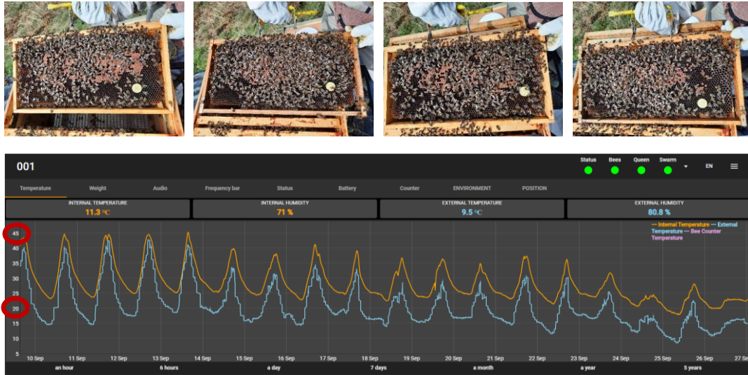
Figura 10. Exemplo de valores de temperatura e humidade do sistema BHM.
