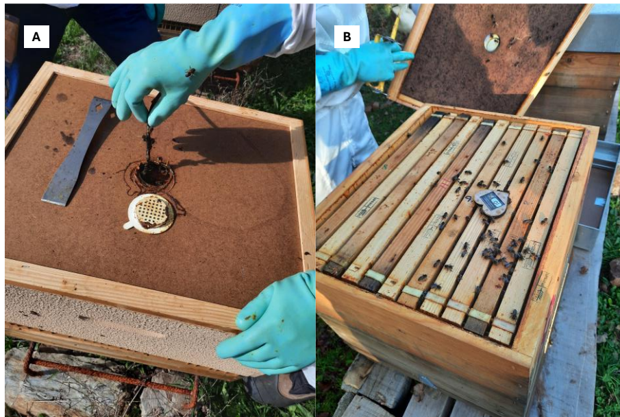
Figura 8. Posición dos dispositivos usados con sensores de temperatura e humidade. (A), sistema Zygi e (B) sistema BeeHiveMonitoring.
