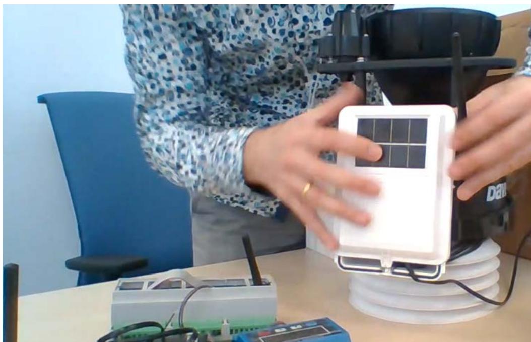
Figura 9.7: Montaxe da ferramenta. Detalle da estación meteorolóxica (dereita), medidor de caudal de auga e sistema de transmisión de datos (abaixo)
