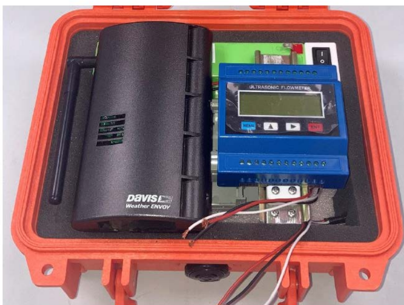
Figura 9.6: Conxunto instalado no maletín, a falta de cablear
