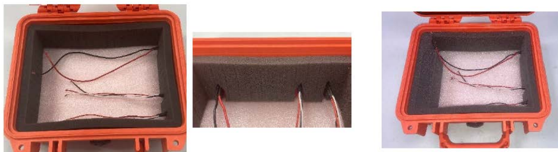
Figura 9.4: Detalle da instalación de conectores no maletín
