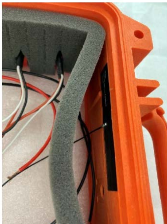
Figura 9.5: Detalle da antena GPRS adhesiva
