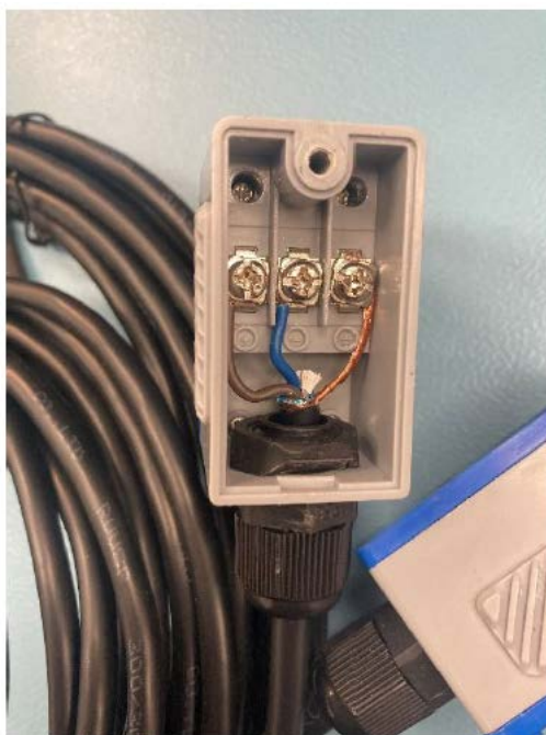
Figura 9.3: Detalle das conexións nos sensores de ultrasóns
