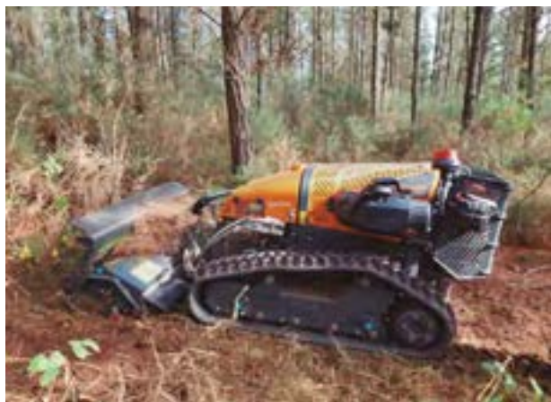
Robot Energreen RoboEVO ensayado en desbroce por calles bajo arbolado.
