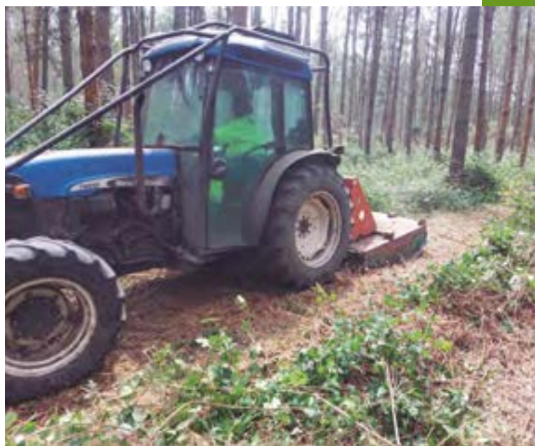
Tractor estrecho Lamborghini F-100 Plus de 100 CV ensayado en desbroce por calles.
