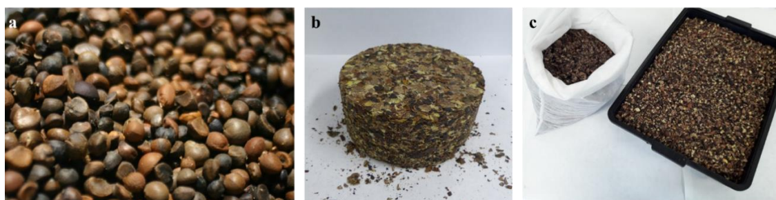
Fig. 2. a) semillas de Camellia ; b) residuo de semillas después de la extracción de aceite (“torta de prensado” o “torta de semillas”); c) residuo de semillas desmenuzado dentro de la bolsa de TNT, listo para iniciar el proceso de obtención del extracto rico en saponina.
