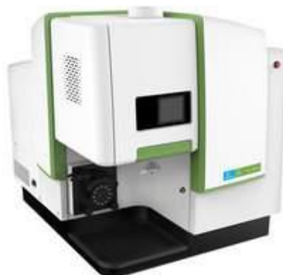
Fig.9. Equipo Perkin Avio 220 Max ICP-OES , empleado para la determinación de elementos (Ca, Mg, Na, K), situado en un laboratorio del Centro Tecnolóxico da Carne (CETECA) .
