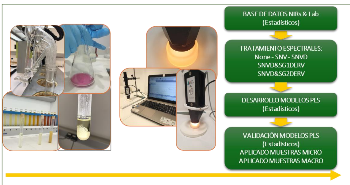
Imaxe 7. Esquema de traballo no desenvolvemento de modelos de predición NIRs
