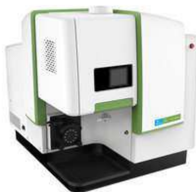
Fig.16. Equipo Perkin Avio 220 Max ICP-OES , empleado para la determinación de elementos (Ca, Mg, Na, K), situado en un laboratorio del Centro Tecnolóxico da Carne (CETECA) .
