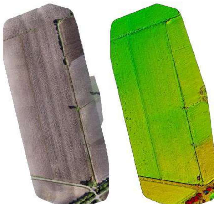
Fig.49. Parcela de ensayos de patata en 2023. Imagen tomada con dron equipado con cámara RGB . Ortomosaico y el correspondiente Modelo Digital de Superficie Dispersa (DSM) antes de la densificación. Imagen procesada el 21/04/2023.
