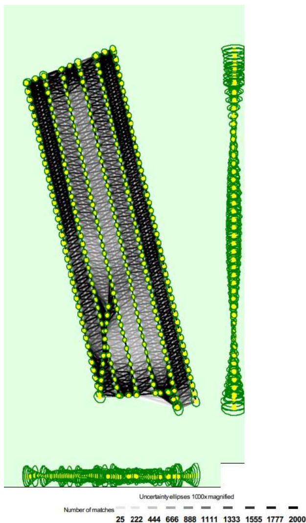
Fig.52. Parcela de ensayos de patata en 2023. Posiciones de imagen calculadas con enlaces entre imágenes coincidentes. La oscuridad de los enlaces indica el número de puntos clave 2D coincidentes entre las imágenes. Los enlaces más claros indican enlaces débiles. Las elipses de color verde oscuro indican la incertidumbre relativa de la posición de la cámara. Imagen procesada el 21/04/2023.
