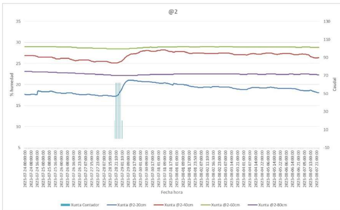
Fig.65. Contenido del agua en el suelo (en %) y caudal de riego a distintas profundidades de suelo, mostrados por el sensor 2, en la parcela de ensayo de patata en 2023.
