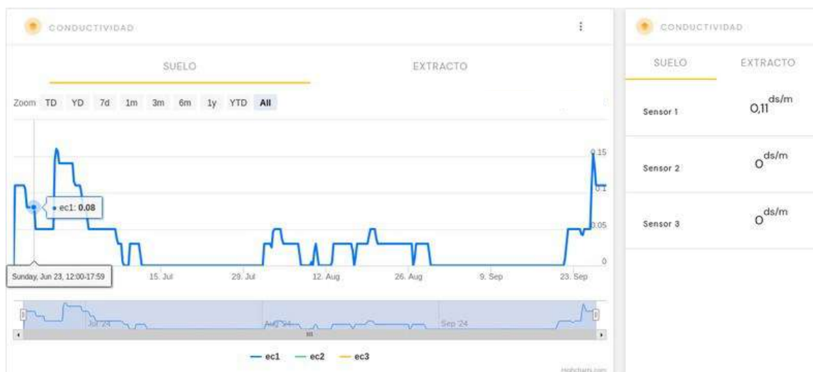
Fig.58. Ejemplo de registro de datos de conductividad eléctrica obtenidos de los sensores colocados en la parcela de ensayos de patata.
