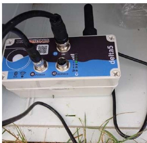
Fig.30. Datalogger (o registrador de datos) para monitoreo y telemetría de sensores, detectores y contadores, para sectorización y macromedición de redes y control de fugas, con registro de caudales, volúmenes, gasto y presiones, y alertas de rotura y fugas.
