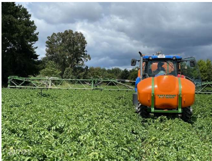
Fig.56. Aplicación de agroquímicos en la parcela de patatas en 2023, mediante un pulverizador/sulfatadora acoplado al tractor.
