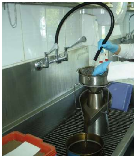
Fig.19. Procedimiento para la extracción de quiste de la patata ( Método de Fenwick ).
