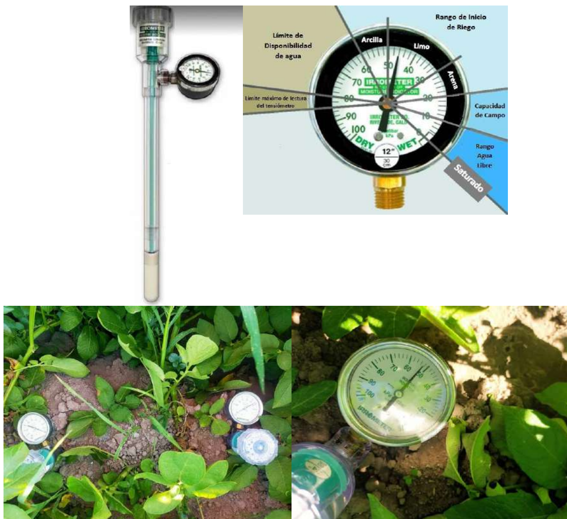
Fig.35. Tensiómetros empleados en la parcela de ensayos.
