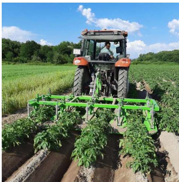
Fig.55. Eliminación de malas hierbas y formación de surco mediante un alomador o conformador acoplado al tractor, en la parcela de ensayos en 2023.
