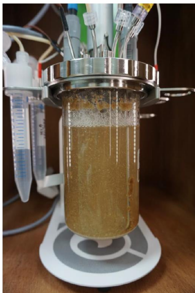
Figura 57. Cultivo de células desdiferenciadas de C. sinensis en un biorreactor de tanque agitado a escala de laboratorio.
