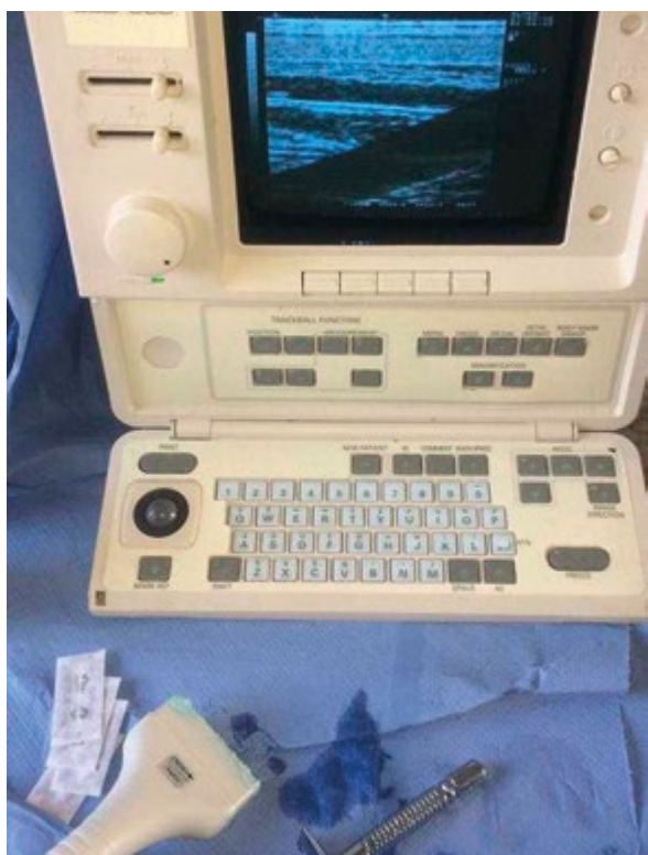
Ecógrafo portátil para a medición do espesor da graxa subcutánea
