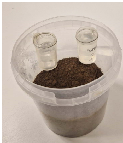
Figura 1.9.2.1. Esquerda: cámara de incubación contendo os ensaios de mineralización da materia orgánica (abaixo) e do nitróxeno (arriba). Dereita: detalle dun recipiente usado para medir a mineralización da materia orgánica aberto mostrando os recipientes de auga e sosa.
