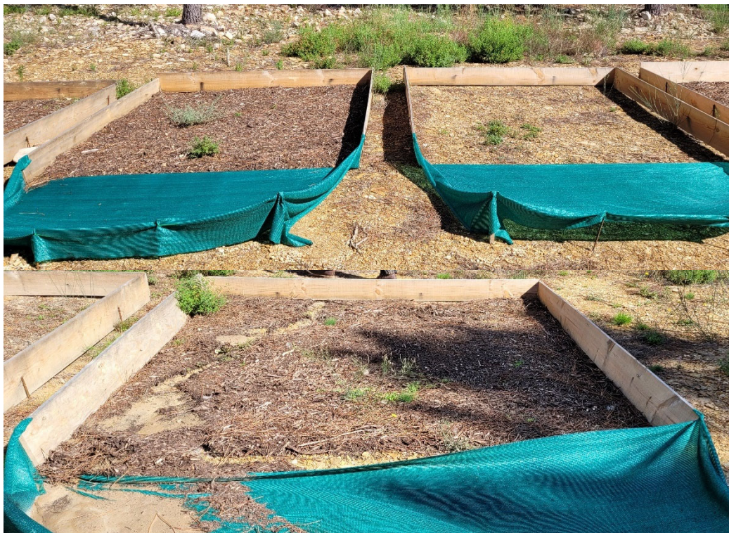
Figura 3.3.4. Fotografías das parcelas do ensaio de degradación do solo na zona do entorno da caseta próxima ao petróglifo tomadas en outubro (apréciase na de baixo a mobilización de material que atravesa a subparcela).
