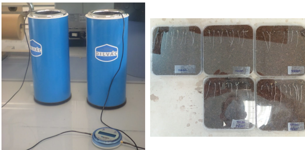
Figura 1.9.1. Test de autoquecemento (esquerda) e bioensaio de xerminación de sementes (dereita) para avaliar respectivamente a estabilidade e madurez dos compost.
