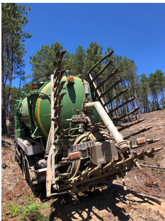
Figura 1.5.1. Transporte do xurro mediante Camión Cisterna.
