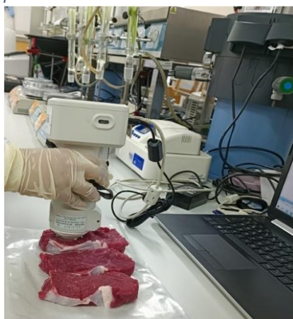
Imaxe . Medición con colorímetro portátil no CETECA
