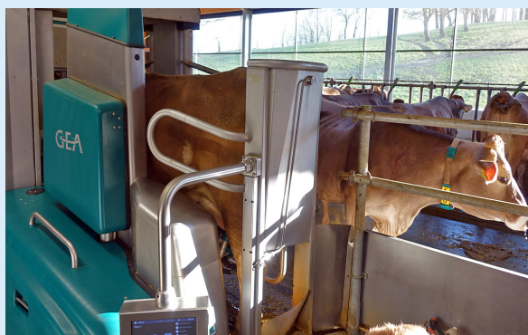
Robot de muxidura
