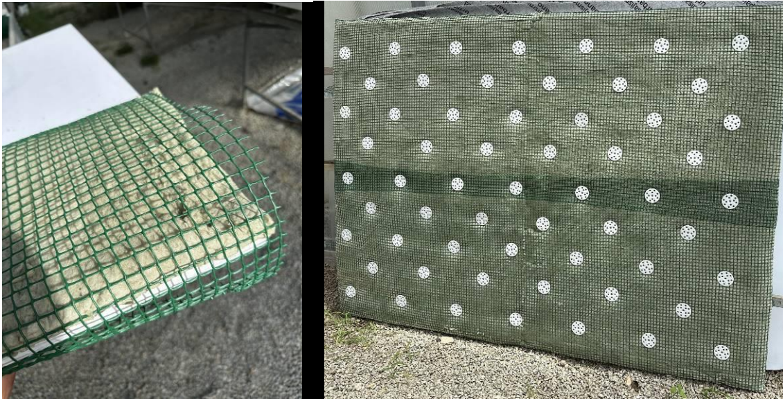
Figura 35. Sistema en lana de roca, detalle de los materiales (derecha) y panel de 1,5 x 2 m montado y preparado para su instalación (derecha)
