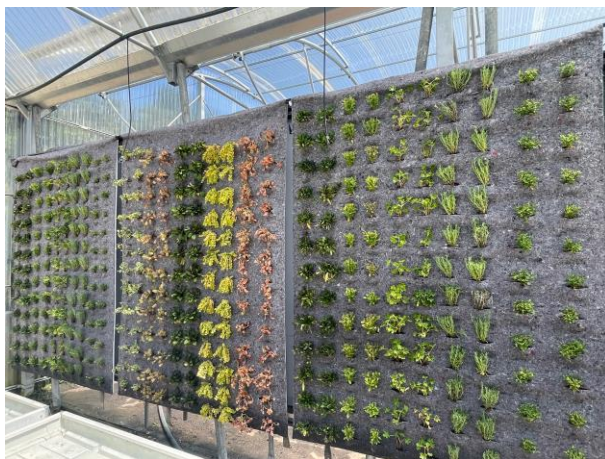
Figura 49. Visión general del ensayo de dos sistemas hidropónicos. A la izquierda paneles de tela de fieltro y a la derecha paneles de lana de roca.
