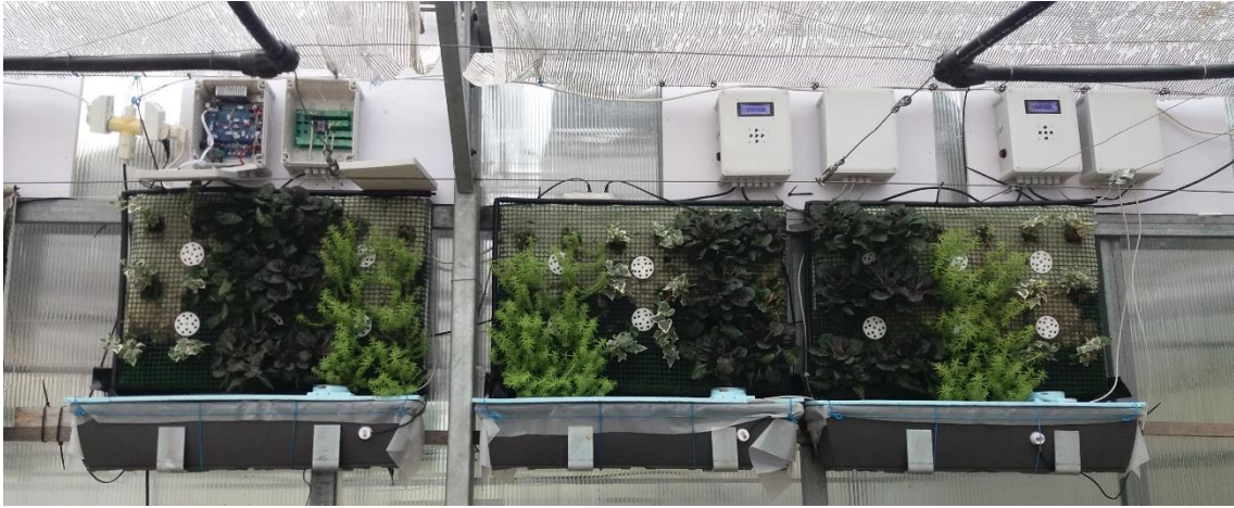
Figura 32. Dataloggers, cajas de auxiliares de conexiones y sensores montados en jardines
