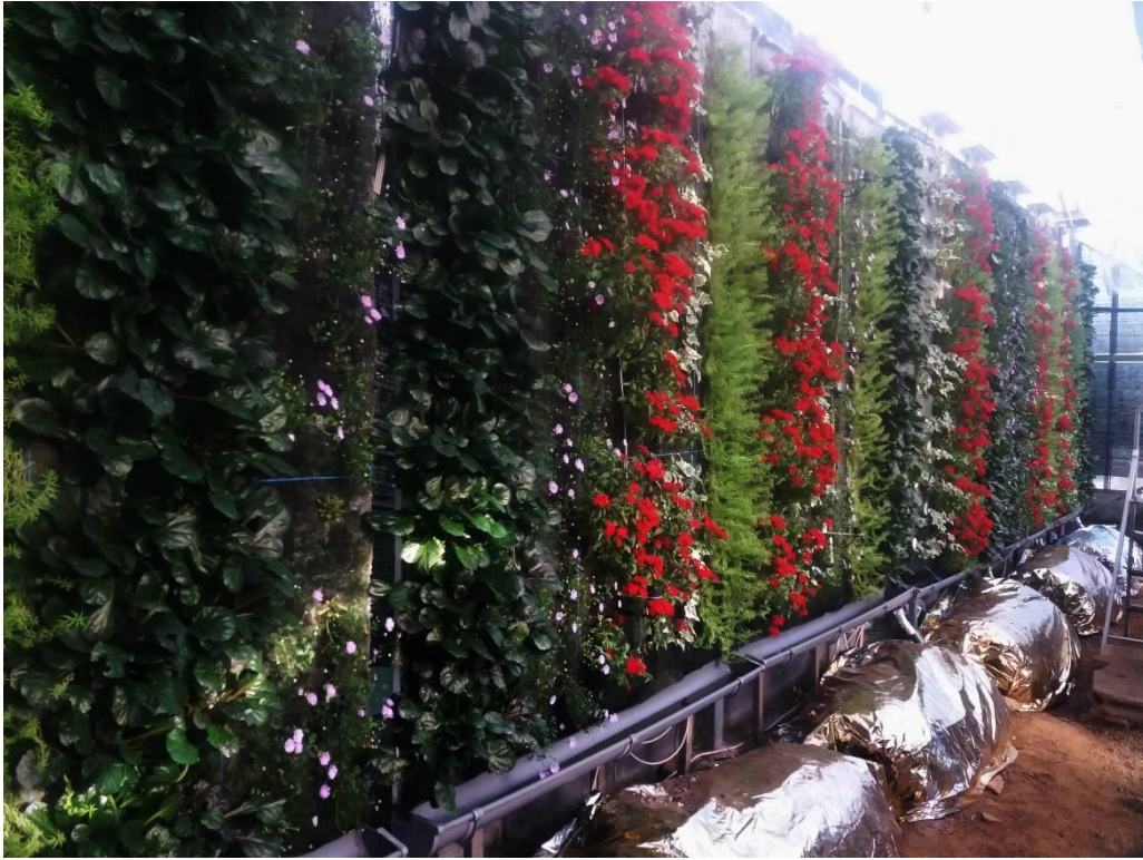
Figura 36. Vista general de los 6 paneles grandes en ensayo: tela con bolsillos (izquierda) y lana de roca (derecha)
