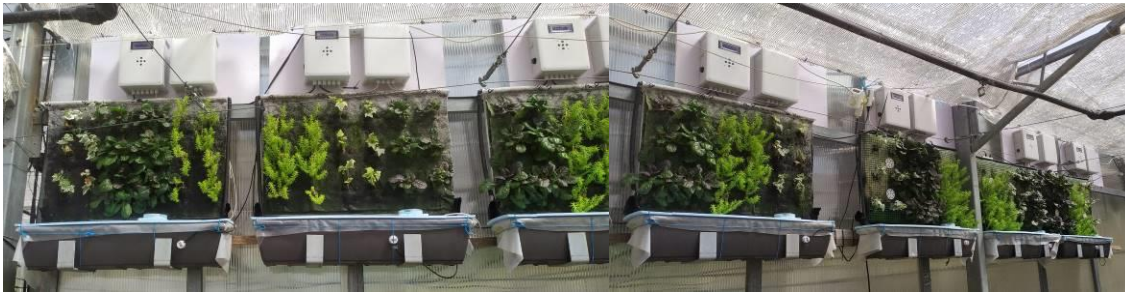
Figura 37. Vista general de los 6 paneles pequeños en ensayo: tela con bolsillos (izquierda) y lana de roca (derecha)
