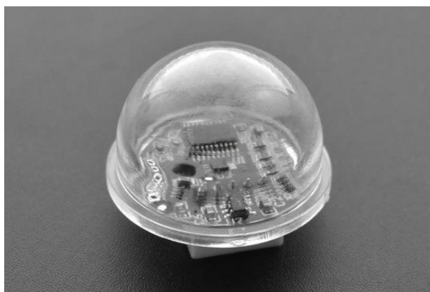
Figura 21. Sensor de luz ambiental.
