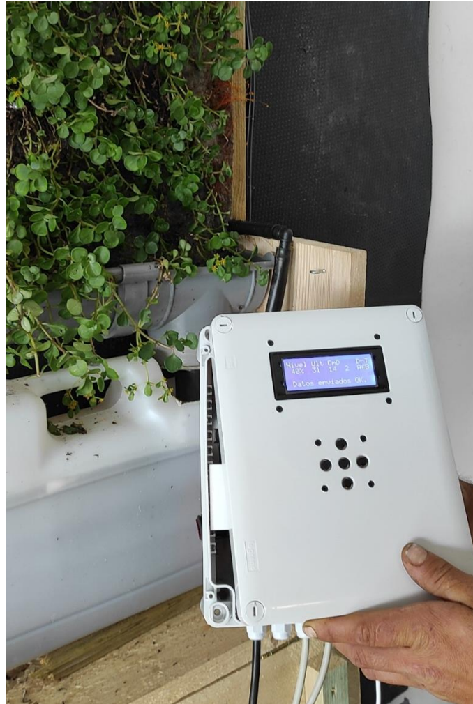
Figura 46. Instalación del prototipo final (sin caja auxiliar de conexiones)
