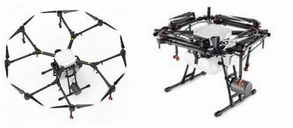
La configuración usada en modo aplicación y plegada.
