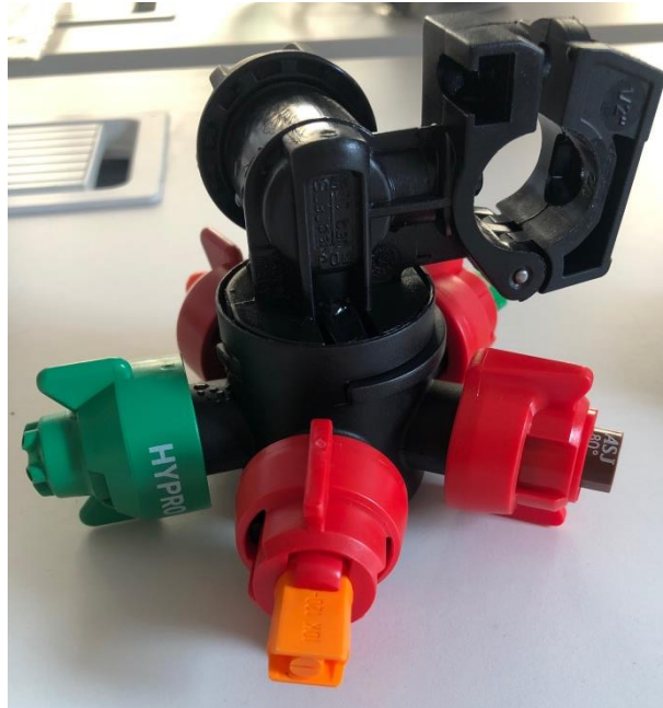
Portaboquillas con las 5 boquillas elegidas
