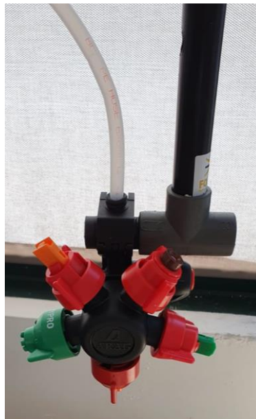
Portaboquillas con las 5 boquillas elegidas y colocadas en el dron
