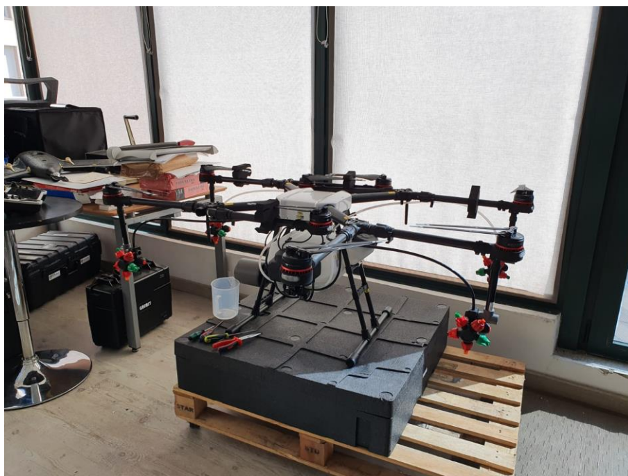
Portaboquillas con las 5 boquillas elegidas y colocadas en el dron
