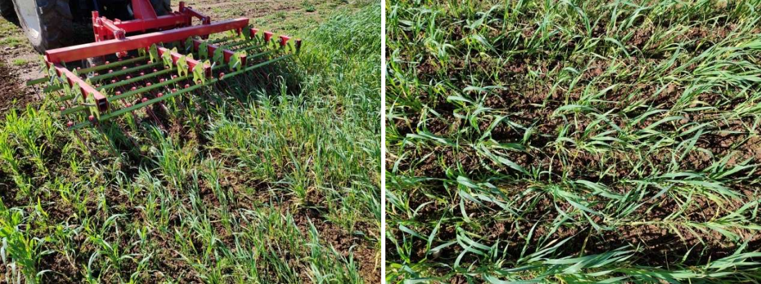
Fotos 8 y 9. Escarda de púas en MAB (07/03/2022) y detalle
