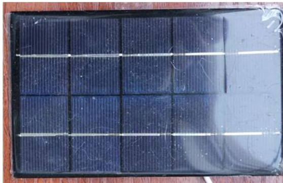
Ilustración 29: panel solar de alimentación.
