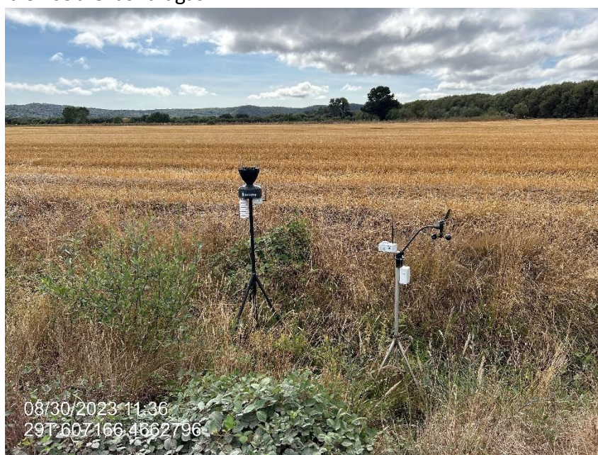
Ilustración 6: estación XUNTA termo pluviométrica con sensores de viento y solar
