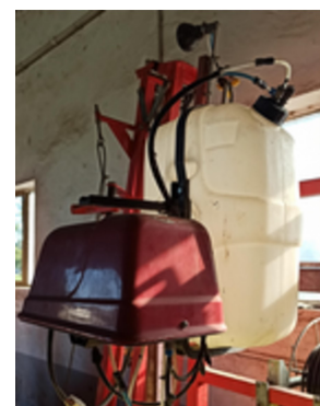
Ilustración 96. Depósito de espuma
