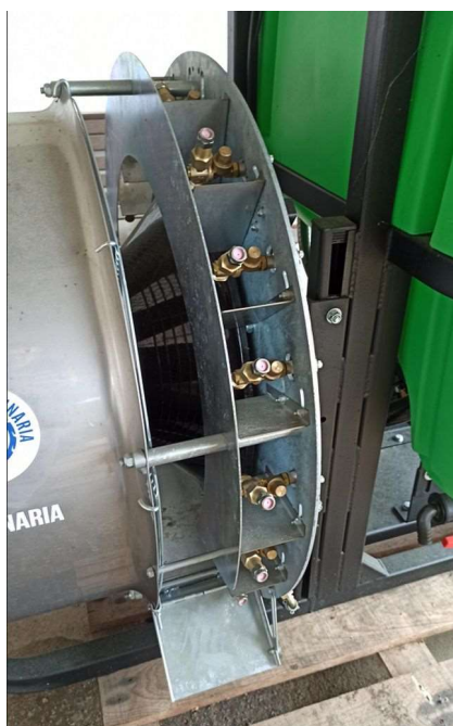
Ilustración 107. Detalle do arco portaboquillas dun atomizador suspendido do tractor
