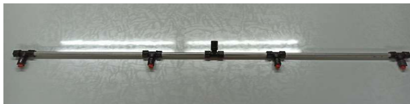
Ilustración 144. Barra portaboquillas con 4 boquillas
