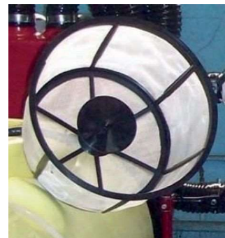
Ilustración 104. Filtro na boca de entrada do depósito
