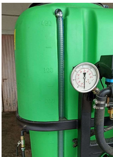
Ilustración 93. Depósito de caldo con indicar de nivel (ata 400 l)
