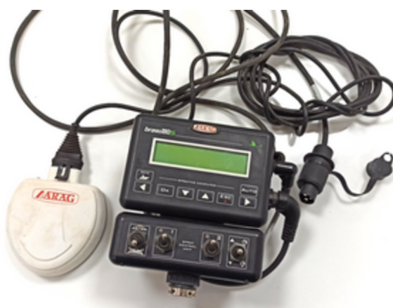
Ilustración 128. Ordenador Arag Bravo 180S para a regulación electrónica dun atomizador
