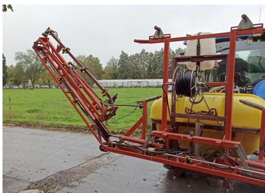
Ilustración 131. Barra portaboquillas en proceso de extensión
