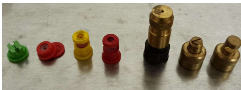
Ilustración 114. Boquillas de plástico, cerámicas e de latón
