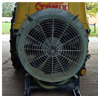
Ilustración 132. Reixa de protección do ventilador
