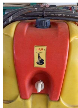
Ilustración 94. Depósito de auga limpa
