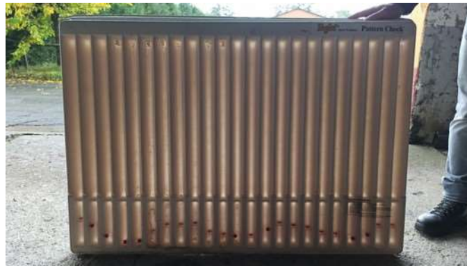
Ilustración 157. Perfil de distribución vertical: boquillas demasiado baixas
