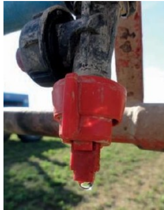
Ilustración 8: Funcionamento incorrecto do dispositivo antigoteo
