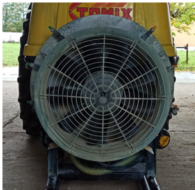
Ilustración 3: Reixa de protección do ventilador
