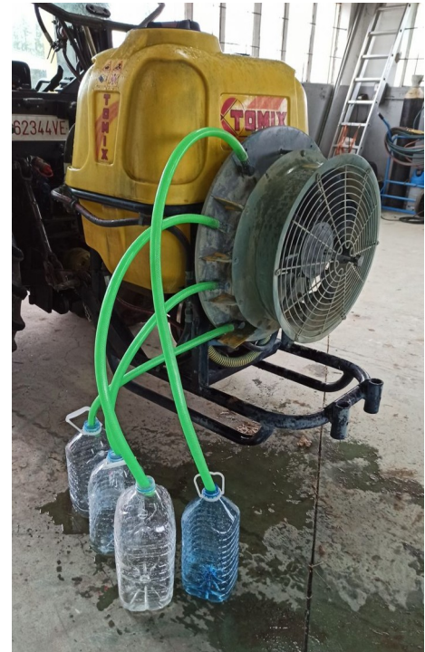
Ilustración 72: Comprobación do caudal das boquillas
