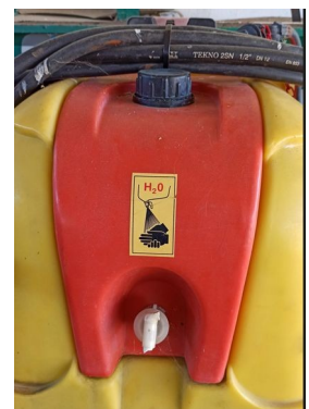
Ilustración 29. Depósito de auga limpa
