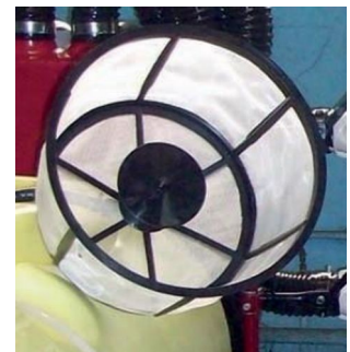
Ilustración 39. Filtro na boca de entrada do depósito
