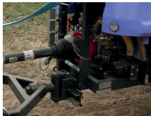
Ilustración 4: Toma de forza con protección e cadea de suxeición correcta
