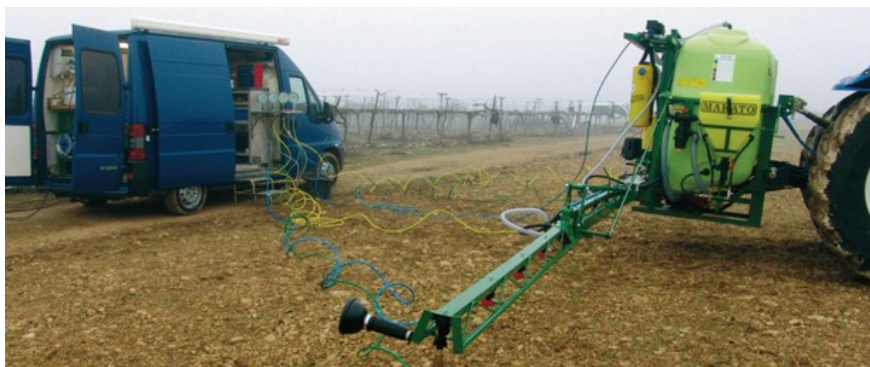
Ilustración 2: Inspección de barra pulverizadora
