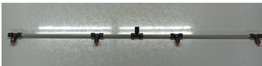
Ilustración 144. Barra portaboquillas con 4 boquillas
