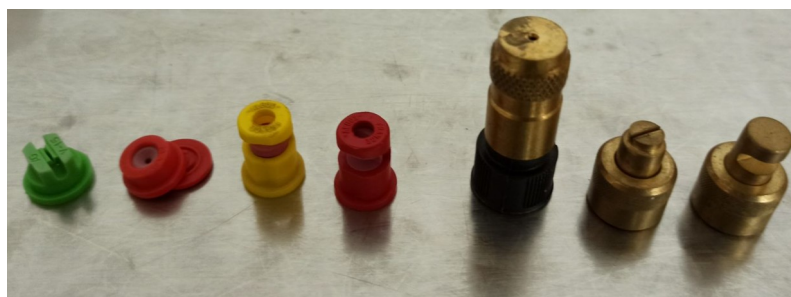
Ilustración 114. Boquillas de plástico, cerámicas e de latón
