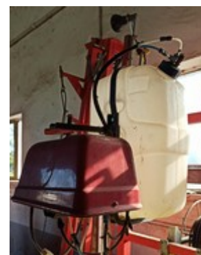
Ilustración 96. Depósito de espuma
