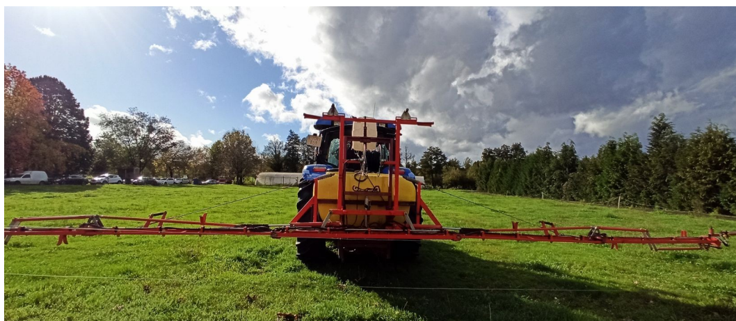
Ilustración 106. Barra portaboquillas dun pulverizador suspendido do tractor
