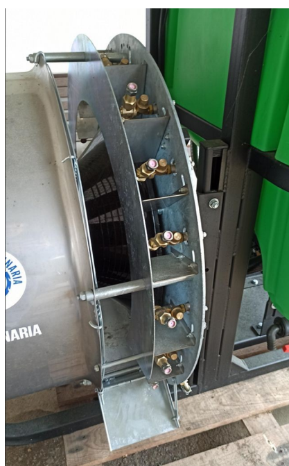
Ilustración 107. Detalle do arco portaboquillas dun atomizador suspendido do tractor
