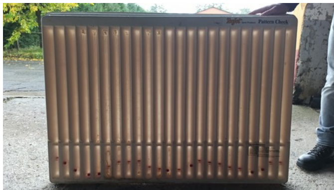
Ilustración 157. Perfil de distribución vertical: boquillas demasiado baixas
