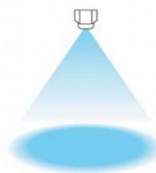
Ilustración 116. Boquilla de cono cheo e modelo de dispersión do chorro
