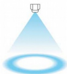
Ilustración 115. Boquilla de cono oco e modelo de dispersión do chorro
