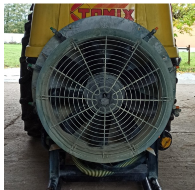
Ilustración 132. Reixa de protección do ventilador
