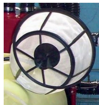
Ilustración 104. Filtro na boca de entrada do depósito
