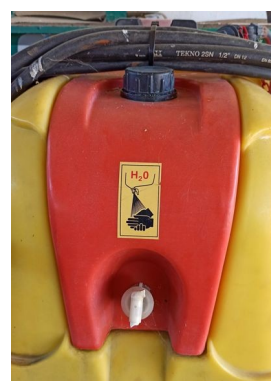
Ilustración 94. Depósito de auga limpa
