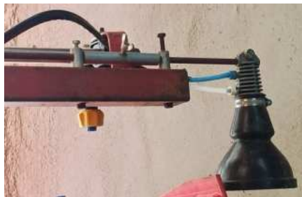
Ilustración 108. Detalle do dispositivo marcador de espuma
