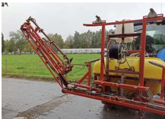
Ilustración 131. Barra portaboquillas en proceso de extensión
