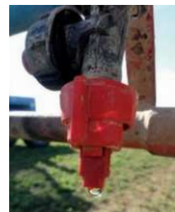
Ilustración 123. Detalle do sistema antigoteo
