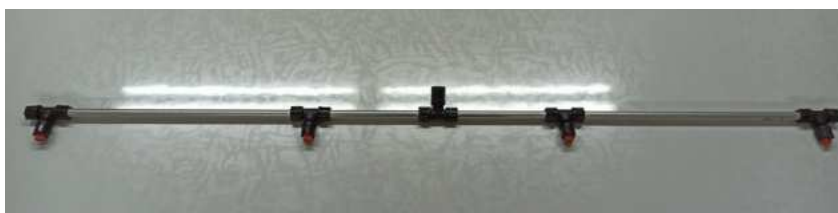
Ilustración 144. Barra portaboquillas con 4 boquillas
