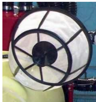
Ilustración 104. Filtro na boca de entrada do depósito
