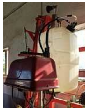
Ilustración 96. Depósito de espuma
