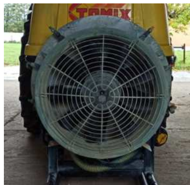
Ilustración 132. Reixa de protección do ventilador
