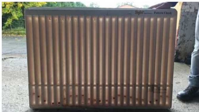
Ilustración 157. Perfil de distribución vertical: boquillas demasiado baixas
