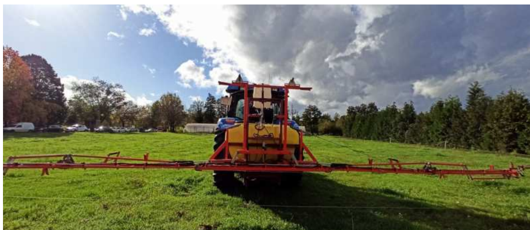
Ilustración 106. Barra portaboquillas dun pulverizador suspendido do tractor
