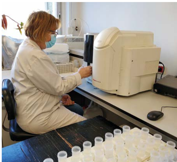
Espectrofotómetro de absorción atómica (para lectura do Ca, Mg, Na e K) (esq.) e espectrofotómetro de UV-visible (para medida de P asimilable)
