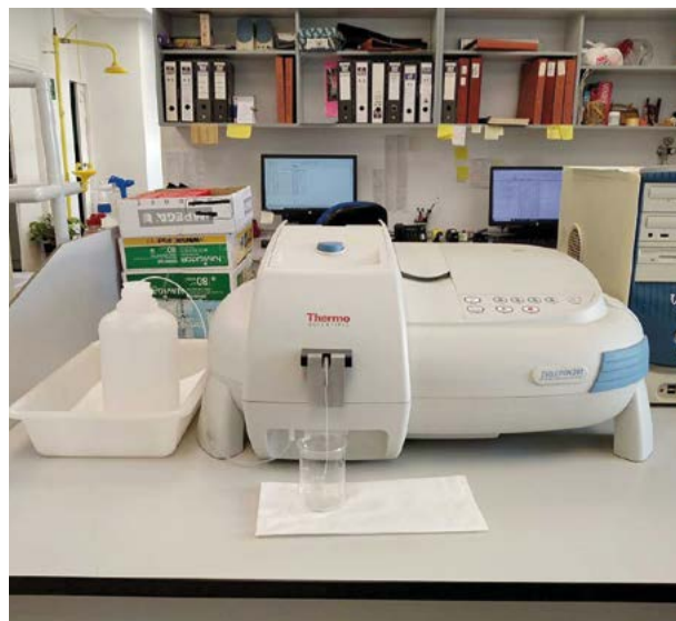
Espectrofotómetro de absorción atómica (para lectura do Ca, Mg, Na e K) (esq.) e espectrofotómetro de UV-visible (para medida de P asimilable)
