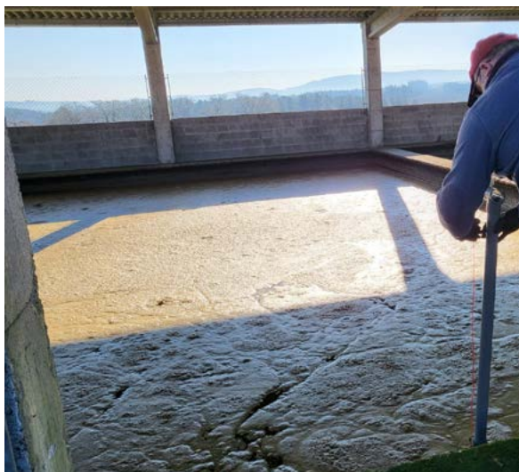
Mostraxe de xurro con tomamostras de columna para a súa posterior análise
