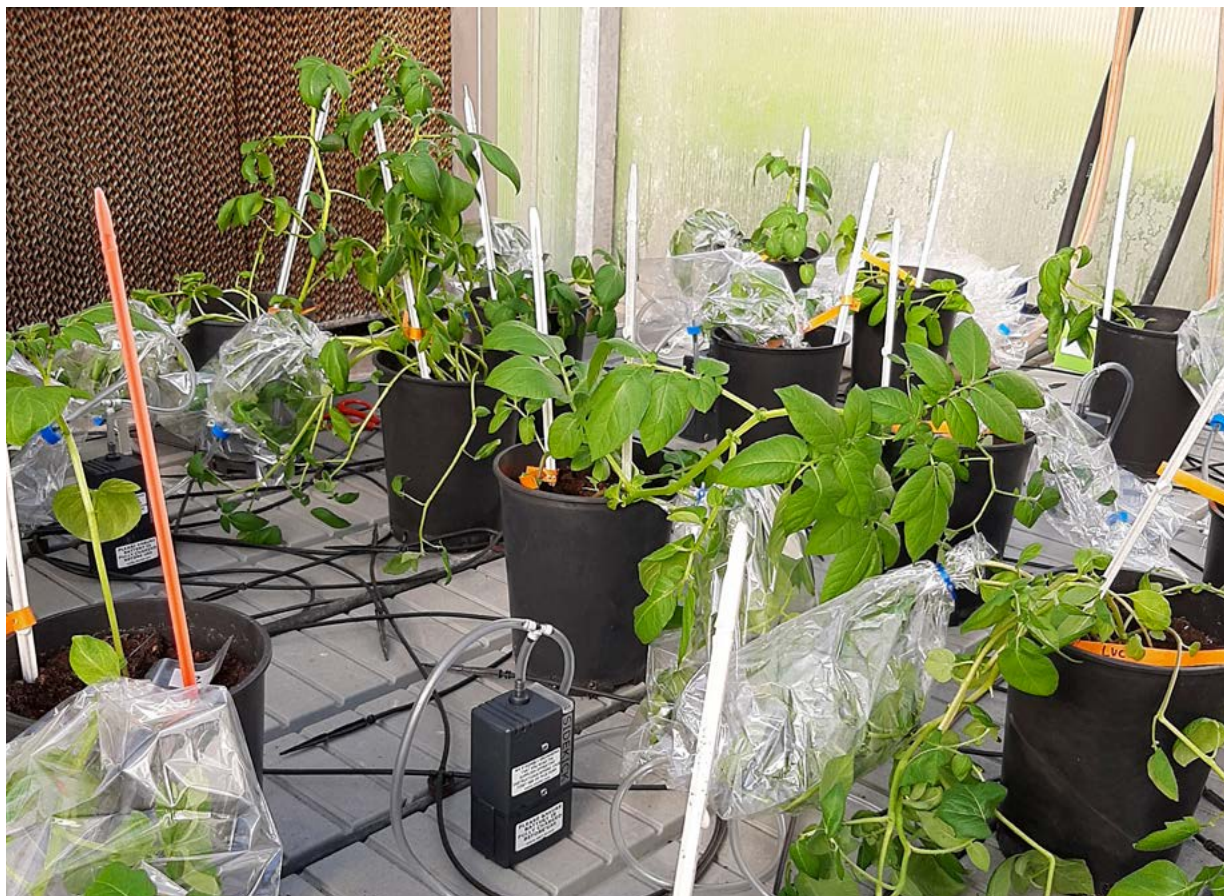
Ensaio de invernadoiro para a extracción de compostos orgánicos volátiles emitidos polas plantas de pataca
