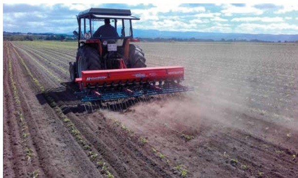
Pase de grade de púas flexibles no estado de 4-5 follas (esq.) e pase da sachadora-aporcadora no estado 6-7 follas
