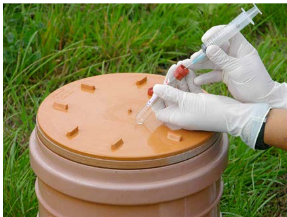
Mostraxe dos gases recollidos nas cámaras de PVC situadas na pradeira fertilizada con xurro ou con fertilizante mineral
