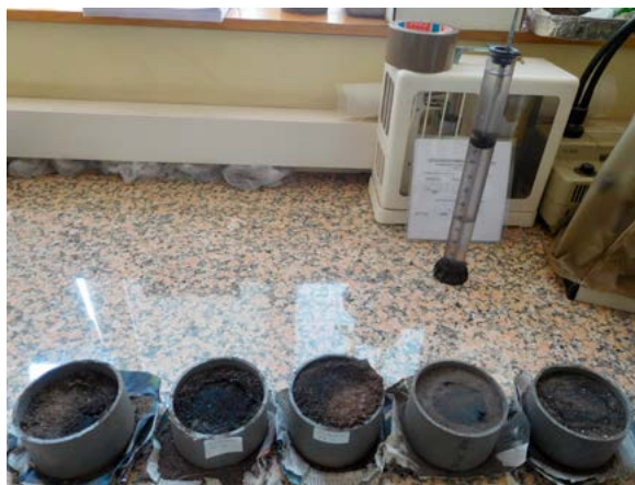
Mostras de solo queimado e mini-infiltrómetro de disco para a determinación da condutividade hidráulica do solo
