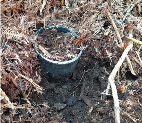
Cilindro coa mostra de solo para a extracción dos microartrópodos
